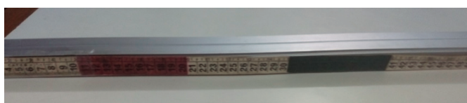
Figura 9: imagem da lateral do trilho com a fita métrica para a medição de distância
