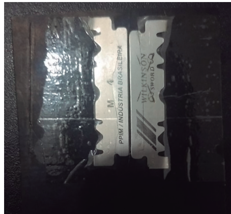
Figura 2: fenda única após a montagem
