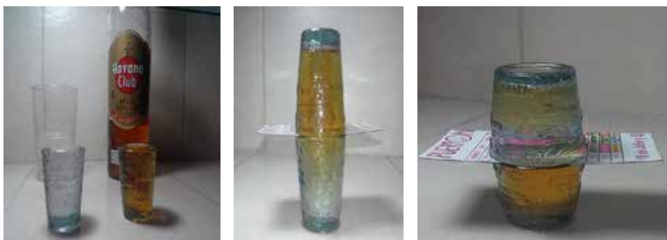
Figura 1. A la izquierda se muestran los dos vasos llenos, uno de agua y el otro de ron. En el centro se puede apreciar como a través de una pequeña abertura regulada por una tarjeta, el ron que está en el vaso superior se va intercambiando con el agua que está en el vaso inferior. A la derecha se ve como prácticamente todo el ron paso al vaso inferior.
