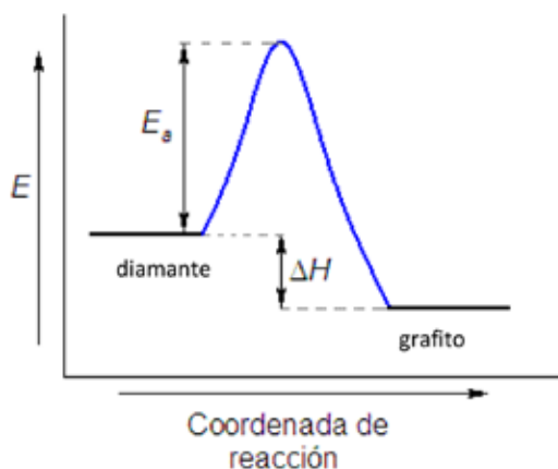
Figura 6. Energía de activación de la transformación de diamante en grafito.
